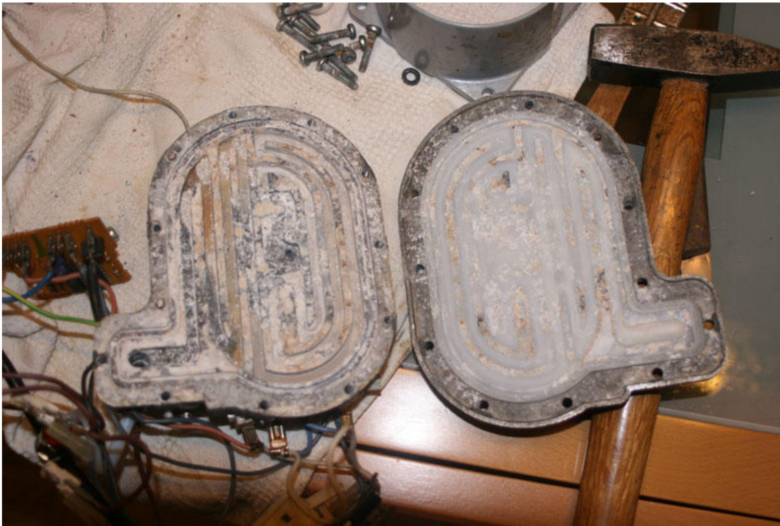
Thermoblock, beide Hälften auseinandergeklappt (Vor der Reinigung). Die Windungen, durch die das Wasser strömt um es zu erhitzen sind deutlich erkennbar.
