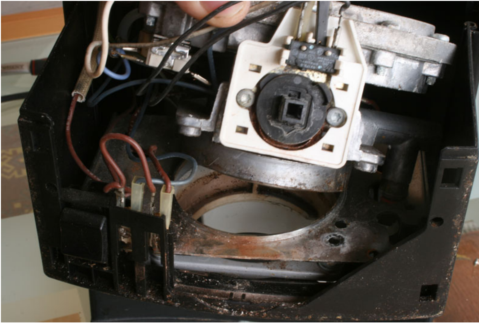
Thermoblock mit Schalter und Gruppe wird aus dem Gehäuse gehoben, nachdem diverse Schrauben gelöst wurden.
