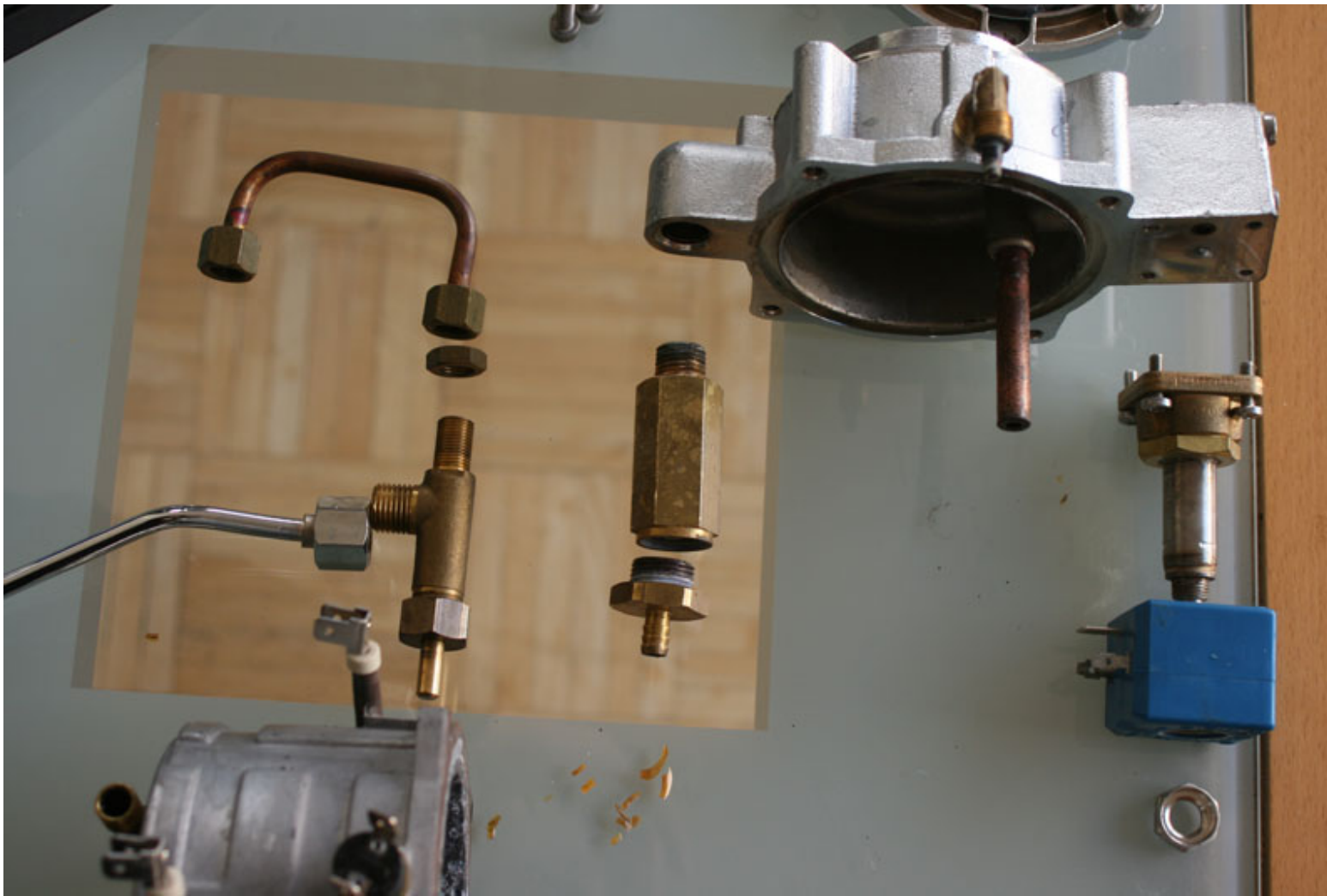
von rechts oben nach links unten: Brühgruppe mit unterem Kesselteil, Magnetventil mit Spule, Kesselfüllstandventil (?), Dampfventil mit Dampfplanze, oberer Alukesselteil mit integrierter Heizspirale.
