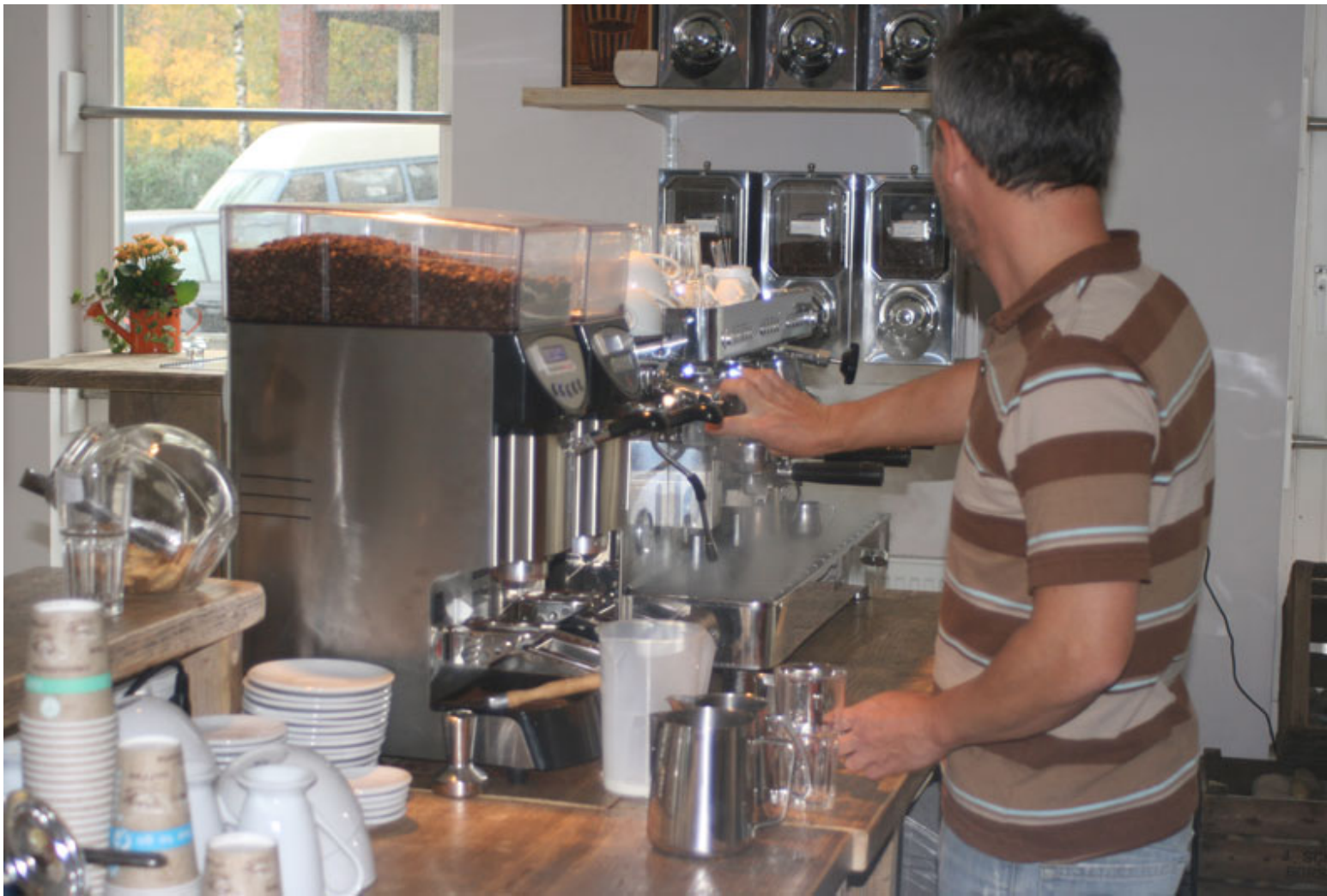
Eine 3-gruppige Vibiemme Replica mit volumetrischer Steuerung ist für die Zubereitung der Kaffeegetränke zuständig.
