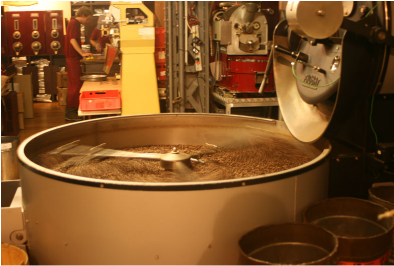
50 KG Probat Röster beim Kühlen der Röstcharge.
